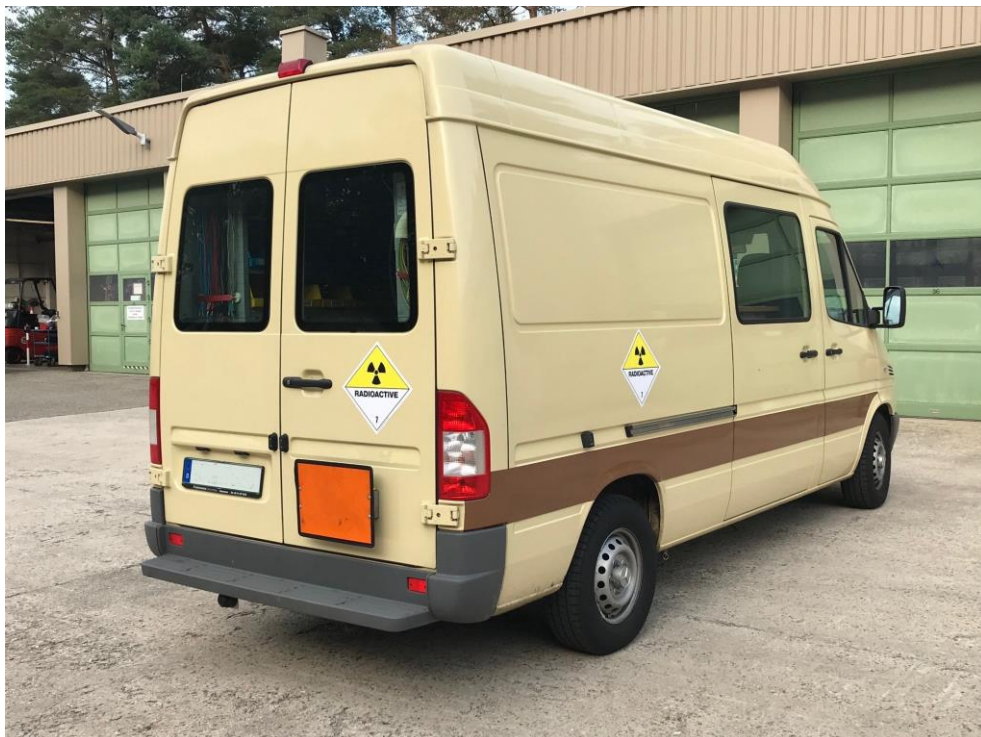
Abb. 3-2: Lieferfahrzeug für den Transport gefährlicher Güter mit den Placards der Klasse 7 „Radioaktive Stoffe“ und orange Warntafel nach ADR
